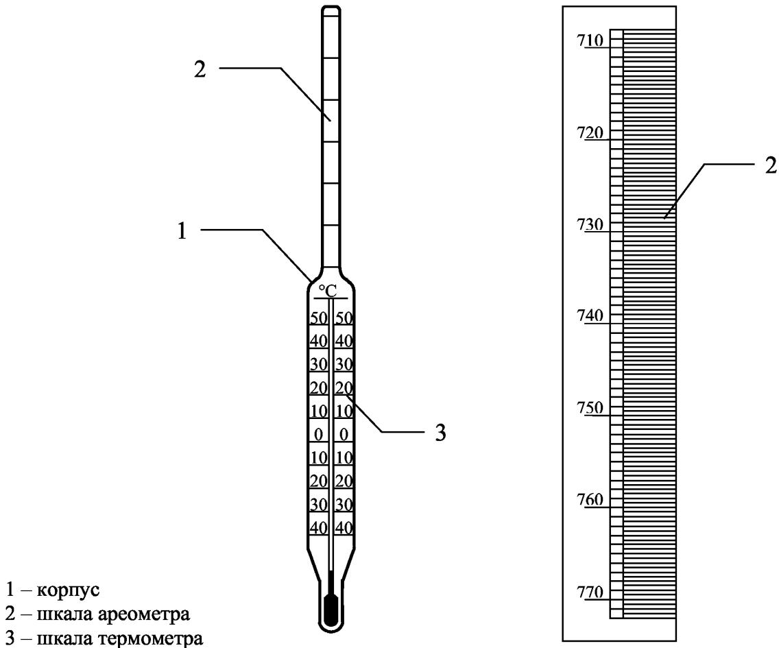
**Рис. 3 Ареометр**
