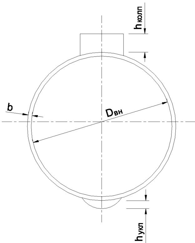
Согласно "Таблицам калибровки железнодорожных цистерн" внутренний диаметр котла цистерны 62 типа калибровки составляет 3000 мм, уклон нижней образующей котла к сливному прибору 30 мм, высота горловины люка относительно верхней образующей котла по внешнему диаметру по результатам замера составила 145 мм, толщина верхней образующей котла 9 мм. Таким образом, высота верхней кромки горловины люка относительно нижней образующей котла цистерны составит
