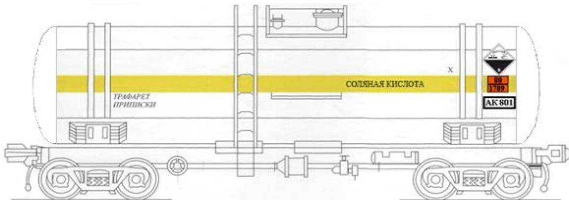
Рисунок. Пример маркировка вагона-цистерны <\*>
