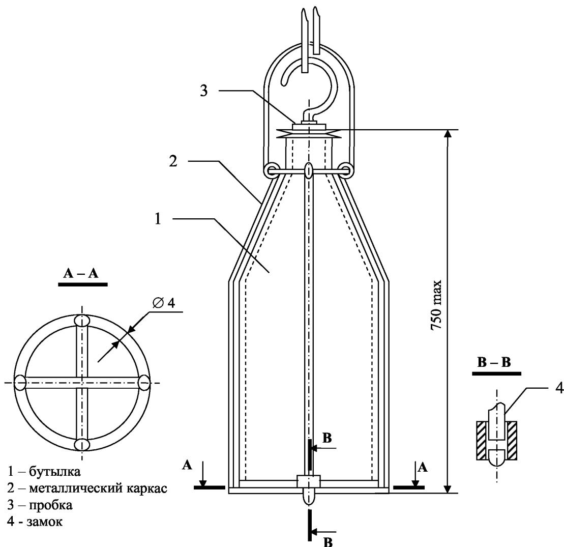
**Рис. 2 Переносной пробоотборник**
